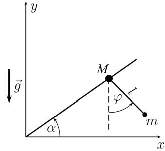
Ein Massenpunkt der Masse  $M$  bewege sich unter dem Einfluss der Schwerkraft auf einer schiefen Ebene mit dem Neigungswinkel  $\alpha$ . An diesem Massenpunkt sei ein ideales Fadenpendel (masseloser Faden der Länge  $l$ ) befestigt.
