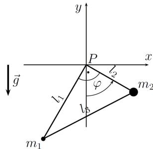
Betrachte das in der Abbildung dargestellte Pendel. Die beiden Massen  $m_1$  und  $m_2$  sind mit einer masselosen starren Stange (der Länge  $l_3$ ) verbunden und mit Hilfe zweier rechtwinklig angeordneter Stangen gleicher Art (mit den Längen  $l_1$  und  $l_2$ ) im Punkt P schwingfähig aufgehängt.
